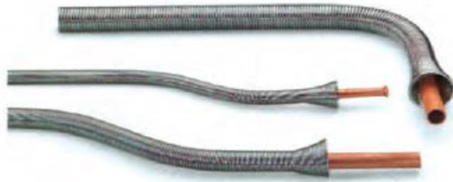
طریقه‌ی خم کردن با استفاده از فنر خم کن لوله‌ی مسی
