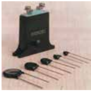
شکل ۱-۱۶- منحنی مقاومت - ولتاژ یک واریستور و نمای ظاهری چند واریستور مختلف
