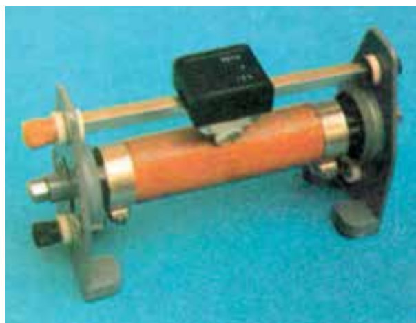
ب - مقاومت سیمی متغیر (رئوستا)
