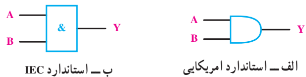
شکل ۱۱-۲ - علائم اختصاری دروازه‌ی AND
