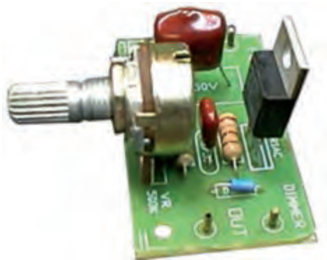
شکل ۳-۵۵- مدار ظاهری یک دیممر روشنایی
