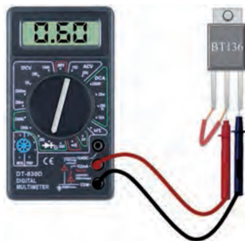
شکل ۱۷-۳- روشن کردن ترایستور توسط مولتی‌متر
