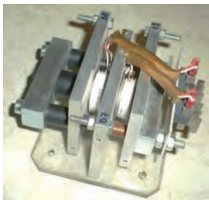
شکل ۳-۳- تریستورهای دیسکی همراه با گرماگیر
