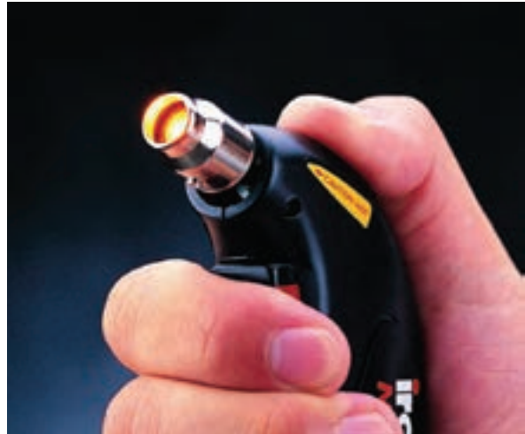
شکل ۱-۶۲- دستگاه گرم‌کن برای وارنیش حرارتی
