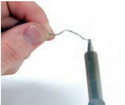
شکل ۴۰-۱- اضافه کردن لحیم به نوک هویه
