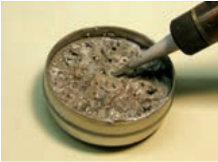
شکل ۳۹-۱- فرو کردن نوک هویه در روغن لحیم
