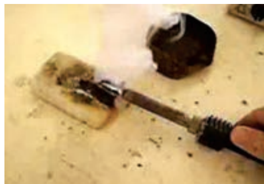
شکل ۳۸-۱- ساده ترین راه تمیز کردن نوک هویه
