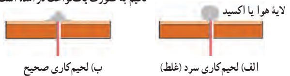
شکل ۱-۴۵- لحیم کاری صحیح و غلط
