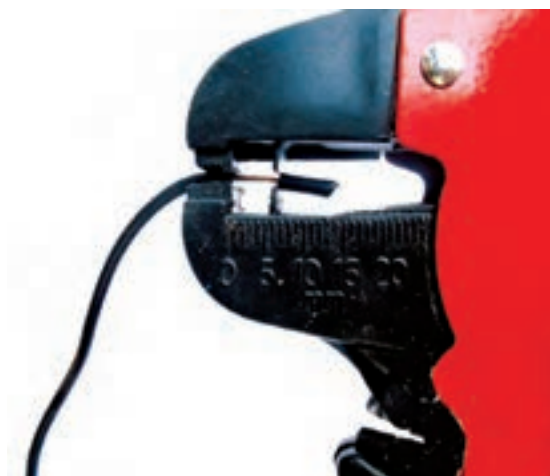
شکل ۱-۴۹- لخت کردن سیم
