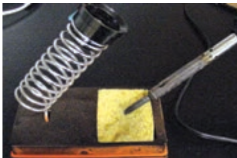
ب) تمیز کردن نوک هویه با اسفنج مخصوص لحیم کاری
