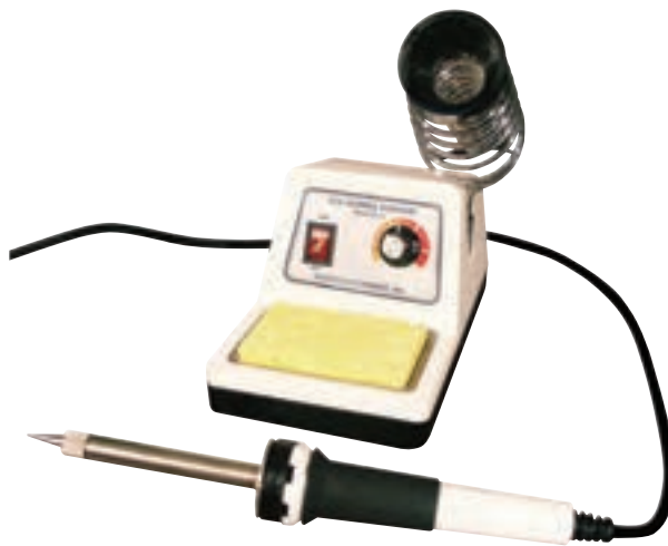
الف) تنظیم درجه حرارت با ولوم
