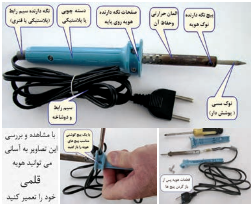
شکل ۲۷-۱- قسمت‌های مختلف یک هویه قلمی
