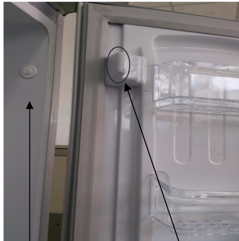
۴۱- قاب مگنت و محل قرار گیری سنسور مغناطیسی مگنت (لادری)
