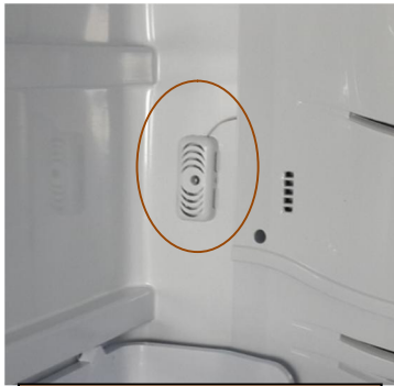
۳۸- سنسور دمای استوانه ای داخل قاب سنسور
