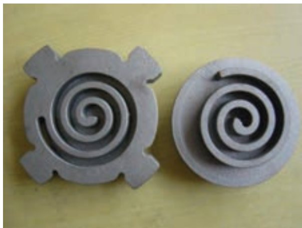
شکل ۳-۸- اسکرول ثابت و اسکرول متحرک
