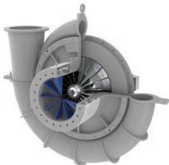
شکل ۳-۳- ماده سرمازا از مرکز وارد پروانه شده و در اثر نیروی گریز از مرکز از محیط روتور خارج می‌شود.
