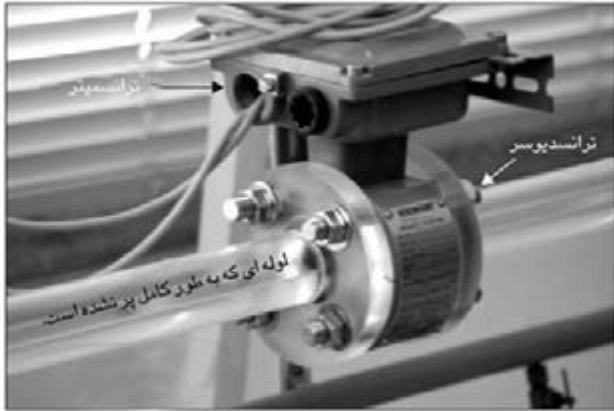
شکل ۸- فلومتر الکترومغناطیسی در شرایطی که لوله کامل پر نشده است (شارمتر Rosemont مدل 8712C)
