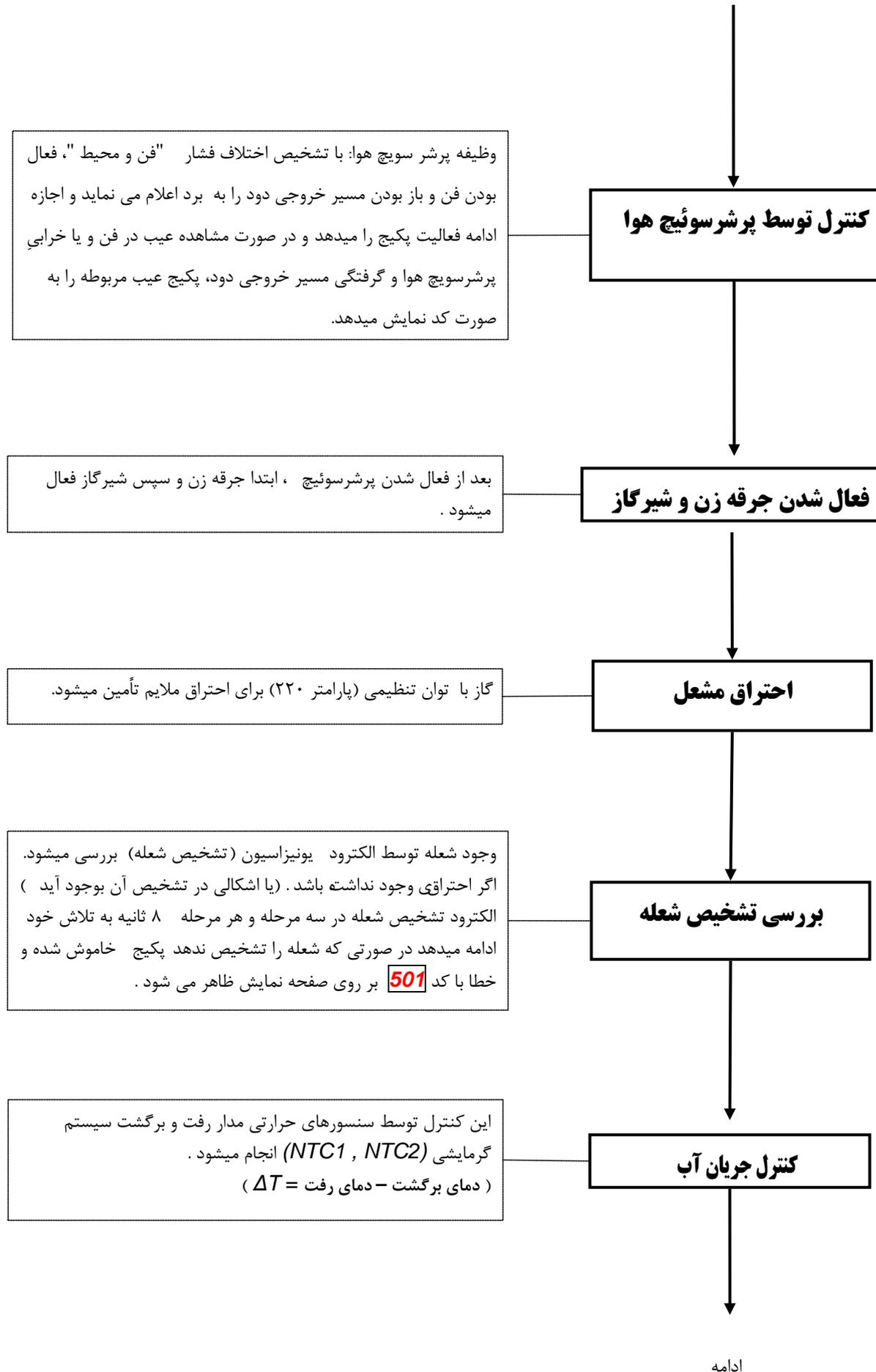
پس از تشخیص شعله توسط یونهای تشخیصی، پکیج توان شعله را مطابق با گرمای درخواستی تنظیم میکند. این مد ولاسیون بین حداکثر مقدار توان گرمایشی (قابل تنظیم از روی کنترل پانل با پارامتر 231) و حداقل مقدار توان (تنظیم شده بر روی شیر گاز) صورت می گیرد.
