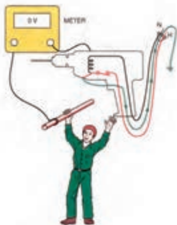
شکل ۴-۲۶ دستگاه دریل دارای سیم ارت
