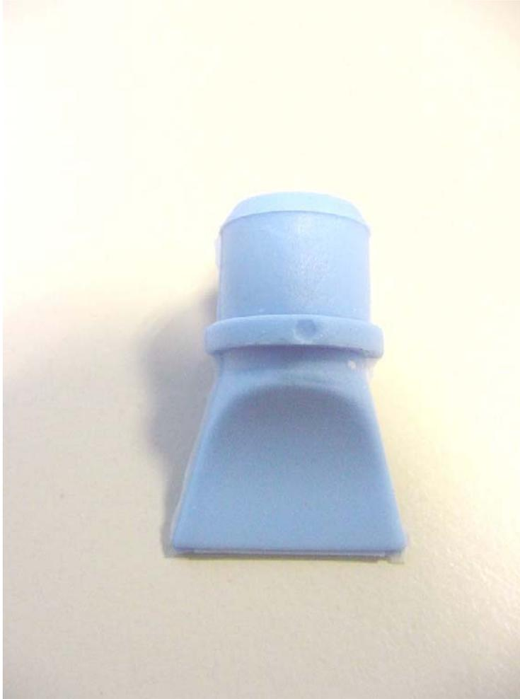
Hervorgerufen durch den dadurch entstehenden Unterdruck wird Luft über die Kondenswasseröffnung eingesogen. Die Dichtlippe dieses Gummiventils oberhalb der Kondenswasserschale verursacht diese Geräusche.
