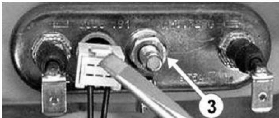
۱- اتصالات الکترونیکی ۲- سنسور دما ۳- مهره ۱۰ میلیمتری
