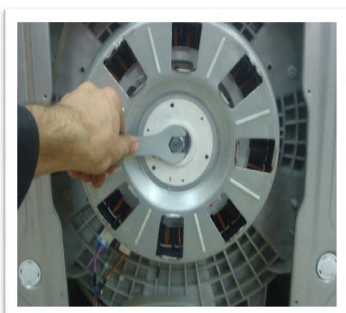
**4**- در صورت عدم وجود ایراد در موارد فوق ، امکان وجود ایراد روی هال سنسور ها را بررسی کنید در صورت خرابی این سنسورها با تعویض قطعه مذکور ایراد برطرف میگردد.
